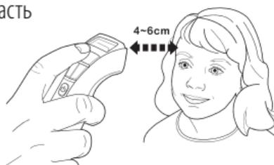
5. Удерживая кнопку «**MEASURE**» (Кнопка сканирования/измерения), медленно перемещайте термометр в направлении лба и от него до тех пор, пока термометр не подаст частый повторяющийся звуковой сигнал, а световой индикатор не начнёт мигать.
