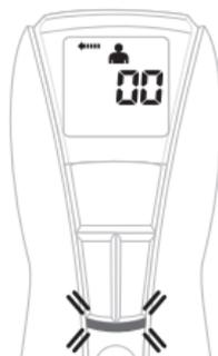
Затем отпустите кнопку «MEASURE» (Кнопка сканирования/измерения). Вы услышите короткий звуковой сигнал, указывающий на то, что измерение произведено.
