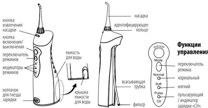
Для включения и выключения прибора нажмите кнопку «On/off». Нажмите на кнопку переключения режима «Mode» и выберите необходимый режим водяной струи (нормальный, мягкий, пульсирующий). Индикатор режима покажет ранее выбранный режим. Если хотите использовать другой режим, нажмите на переключатель режима до тех пор, пока не будет достигнута необходимая настройка. Нажатие на переключатель режима будет изменять режим с нормального («Normal») на мягкий («Soft») и пульсирующий («Pulse»).
