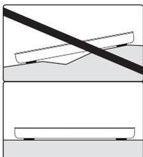
Установить весы на прочную ровную поверхность.
