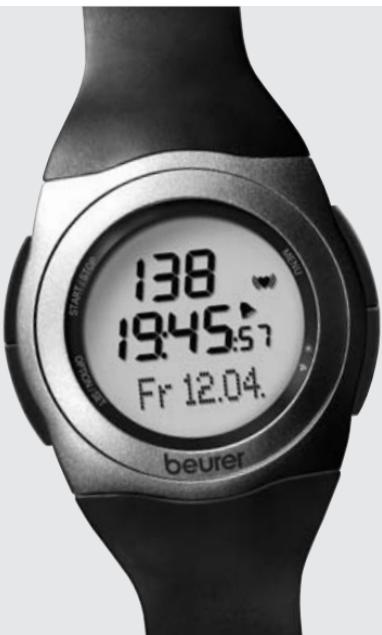
Данный пульсотахограф обладает водонепроницаемыми свойствами , таким образом, допускается его использование при плавании. Однако ЗАПРЕЩАЕТСЯ нажимать кнопки под водой , будет нарушена герметичность прибора. Измерения под водой производиться не будут ввиду невозможности передачи сигнала.
