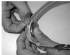
На верхней и нижней кромке корпуса находится четыре небольших фиксирующих крючка (1). Ремешок имеет соответствующие прорезы (2). Вложите корпус в ремешок. Осторожно проведите дужки (3), которые охватывают боковые кнопки, через кнопки.
