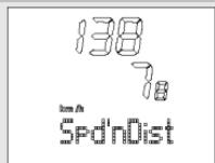
Как только Вы попадаете в меню Spd'nDist, пульсокардиограф автоматически переходит на основную индикацию. Она показывает в средней строке текущую скорость. Нижняя строка указывает среднюю частоту пульса.
