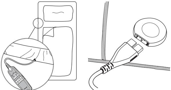
Затем натяните электрическую простыню на матрац со всех сторон, как натяжную простыню. Электрическая простыня рассчитана на использование с матрациами 90 x 200 см и 100 x 200 см. Если длины кабеля не хватает, то Вы можете дополнительно заказать более длинный кабель (арт. № 108.424) в сервисной службе. Затем закрепите свою натяжную простыню как обычно, так, чтобы электрическая простыня находилась между Вашим матрацом и натяжной простыней.
