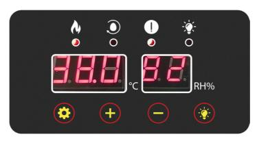
Над экранами дисплея слева направо находятся световые индикаторы: функции подогрева, поворота яиц, сигнализации и светодиодного овоскопа.
