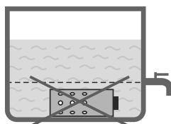
Эксплуатируйте устройство только вертикально. В ином положении, в случае слива воды, датчик уровня не защитит устройство, что приведет к дорогостоящему ремонту.
