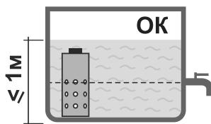
Выставите температуру. Погрузите устройство в сосуд с водой так, что бы уровень воды был выше отверстий на корпусе. Чем ниже устройство будет погружено в емкости, тем равномернее будет прогреваться вода. Найдите оптимальное размещение устройства в емкости, обеспечьте перемешивание воды, для равномерного нагрева. Допустимо погружение на глубину до 1 м.
